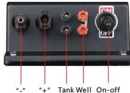
1. Conecte el poste del panel solar "+" y "-" a la caja de conexiones, el indicador de encendido se enciende significa que la energía está encendida. Luego presione el interruptor a la posición ON, la luz indicadora de funcionamiento y el arranque de la bomba.
