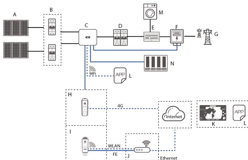
**Figura 2-3** Aplicación de la conexión en red en caso de conexión en cascada de inversores (opcional en las casillas de línea discontinua)
