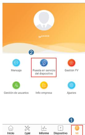
**Paso 2** Conéctese a la red WLAN del inversor. Inicie sesión como **installer**, y realice los **Ajustes rápidos**.
