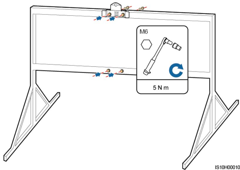
**Paso 4** Coloque el SUN2000 sobre la ménsula de montaje.
