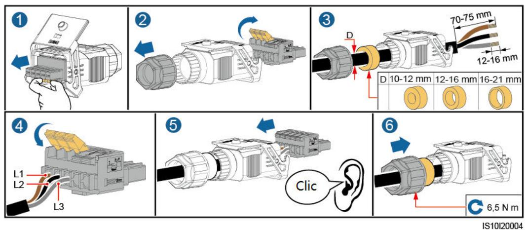
**Figura 5-6** Cable de cuatro conductores (L1, L2, L3 y conexión a tierra)
